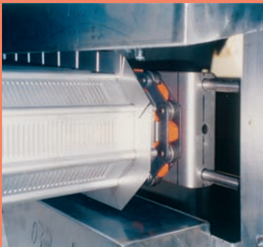
Particolare dei piani a tappeti in alluminio fessurato
