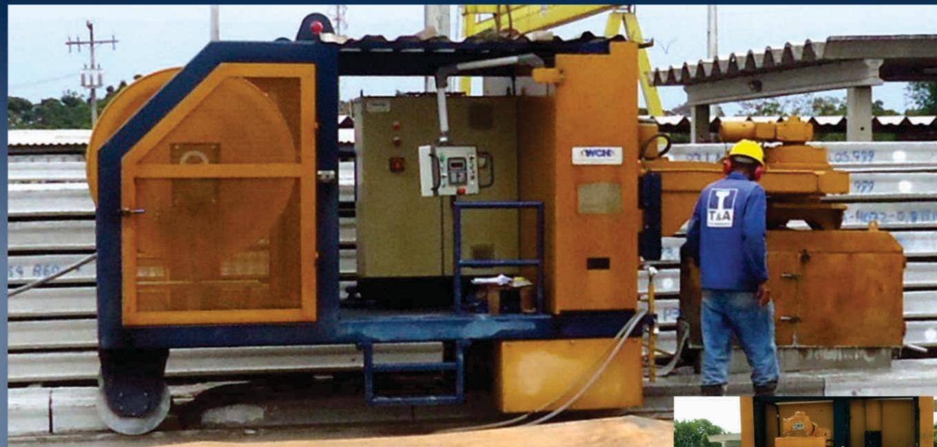
Modelo computadorizado para el corte de paneles y losas pretendidas, permite grande diversidad de cortes complejos como recortes parciales, transversales, longitudinales y angulares.
