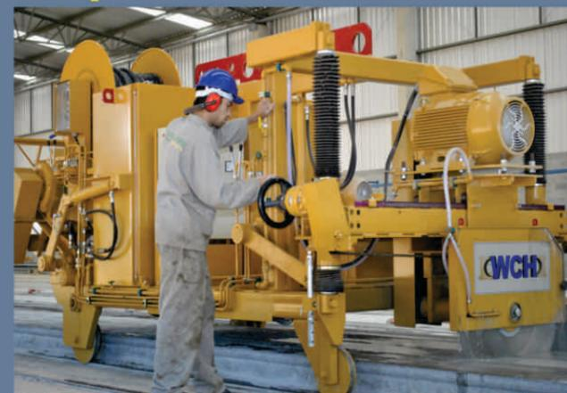
Montada en robusto chasis compuesta de conjunto carretel de cable eléctrico, tanque de agua de 2.000 litros equipado con bomba de agua que garante la refrigeración ideal de corte. Columnas de elevación con baño de cromo duro y sistema de guías largas triplemente protegidas contra impurezas y suciedad, eje del disco de corte montado con rodamientos en baño de aceite para garantizar la máxima durabilidad del equipamiento y del disco de corte eliminando vibraciones perjudiciales.
