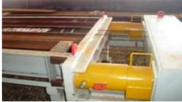
**Apoyos de alivio de los Cilindros de Destensado, tipo HERRADURA:** No permite que los Cilindros sean retirados de la cabecera y transportados de un lugar para el otro, de esta manera, los cilindros no pueden usarse en otra pista para el trabajo de destensado.
