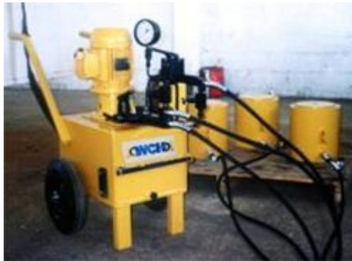
La **Unidad Hidráulica** está armada sobre ruedas y posee el sistema de enganche rápido para la adaptación de los cilindros, lo que permite que la misma sea usada con diferentes cilindros, con facilidad de desplazamiento.
