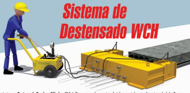
El conjunto para Destensado Bomba y Cilindros Hidráulicos, son usados para transferir levemente la carga de pretensado de los Bancos de Ancoraje para el producto (prefabricado), compuesto de:
