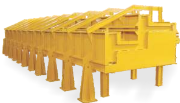
Fôrmas de Arquibancada Stall Molds Formas de Grada
