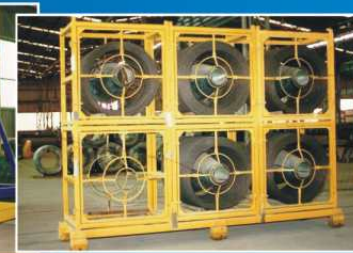
Estación para rollos y cables.
