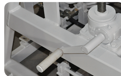
Macaco mecânico para ajuste de altura do silo. Mechanical jack for adjusting silo height. Gato mecánico para ajuste de altura del silo.
